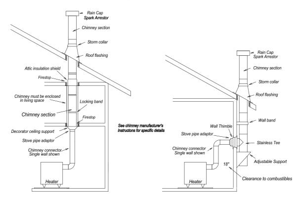
TYPICAL FACTORY BUILT CHIMNEY INSTALLATION
