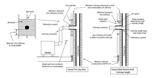
TYPICAL CONNECTION TO A MASONRY CHIMNEY THROUGH A COMBUSTIBLE WALL
