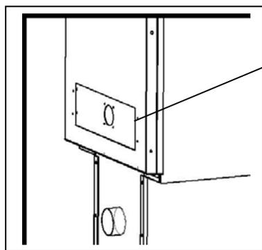
(4) vis autotaraudeuses, tête de 5/16 po (préinstallées dans l'appareil).
