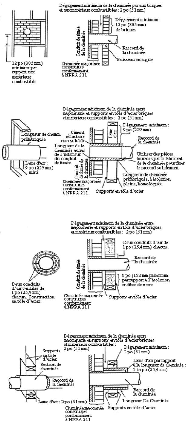
A En brique maçonnées ayant une épaisseur minimale de 3,5 po entièrement encastrée dans le mur avec un cadre et ayant une séparation minimale de 12 po par des briques entre le boisseau en argile et les matériaux combustibles. Le boisseau en argile doit aller de la surface extérieure du mur en briques jusqu'à la surface intérieure de la gaine de la cheminée; il doit être cimenté fermement en place.
