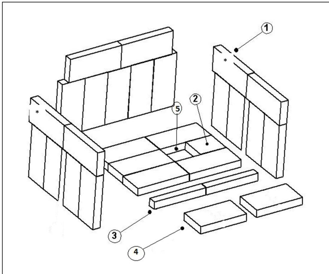
REMARQUE: Les briques sur les côtés et à l'arrière doivent être installés après l'accouplement
